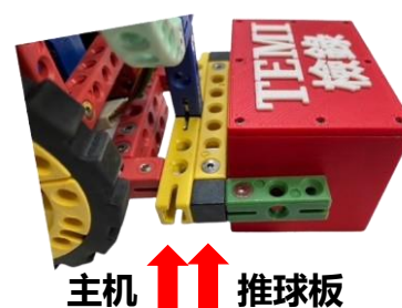
图5、推球板上下面需为净空，不得有推(铲)平面/曲面
