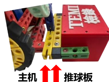
图5、推球板上下面需为净空，不得有推(铲)平面/曲面
